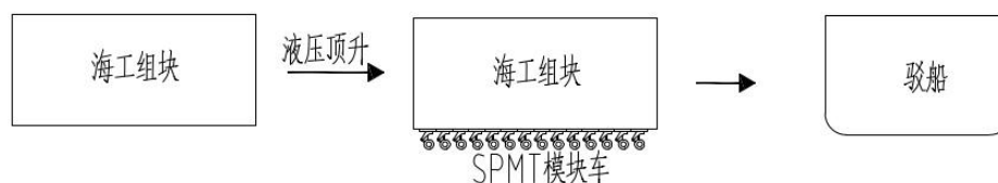
图 3.3-2 滚装出运工艺流程
