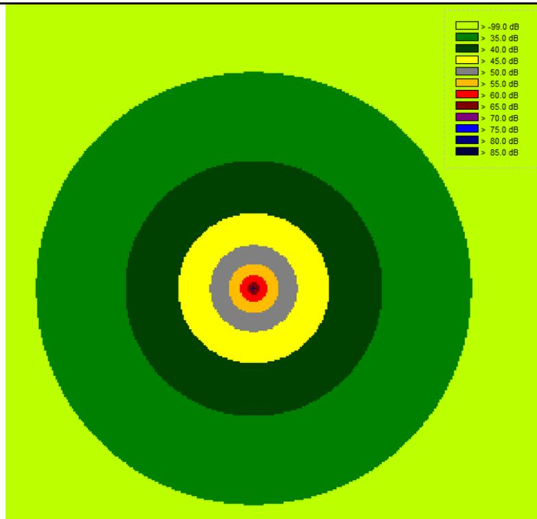
图 4-1 单台风机地面 1.2m 高度噪声等声值线图
