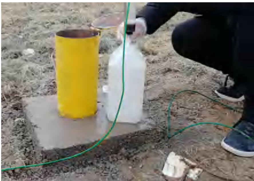
图 4.2-5 地下水取样照片
