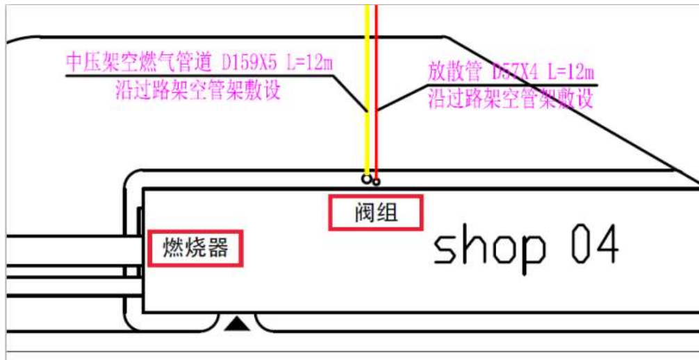
图 1-5 燃烧器和阀组安装位置图 (SHOP04 二楼)
